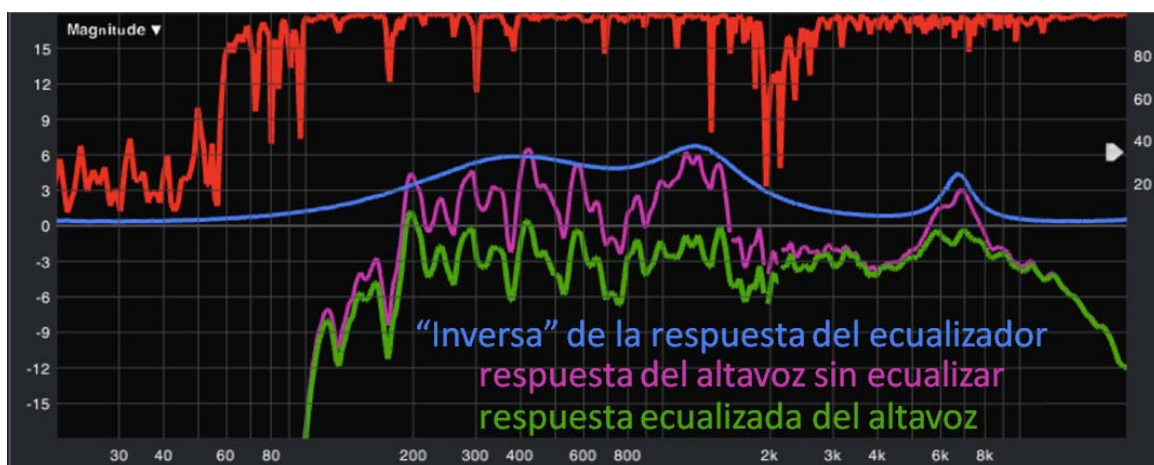
Figura 36: Medición de la Función de Transferencia – Respuesta del altavoz inicial (guardado), Curva del EQ (invertido) y resultado del altavoz ecualizado
