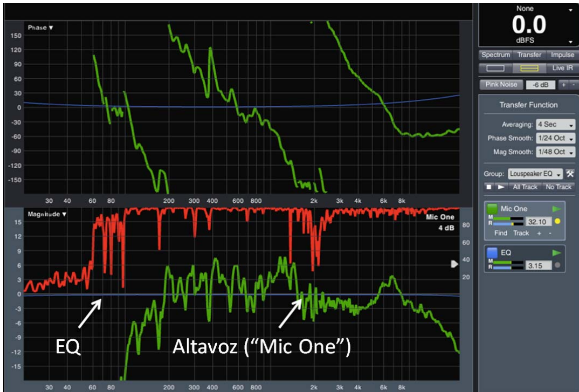
Figura 35: Medición inicial de una Función de Transferencia – Altavoz y Ecuación
